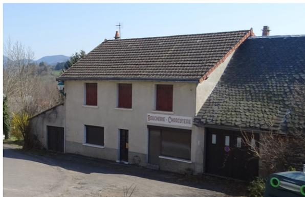
Fenêtres qui s'élargissent, volets métalliques, pente de toit moins forte et couverture en tuile mécanique
